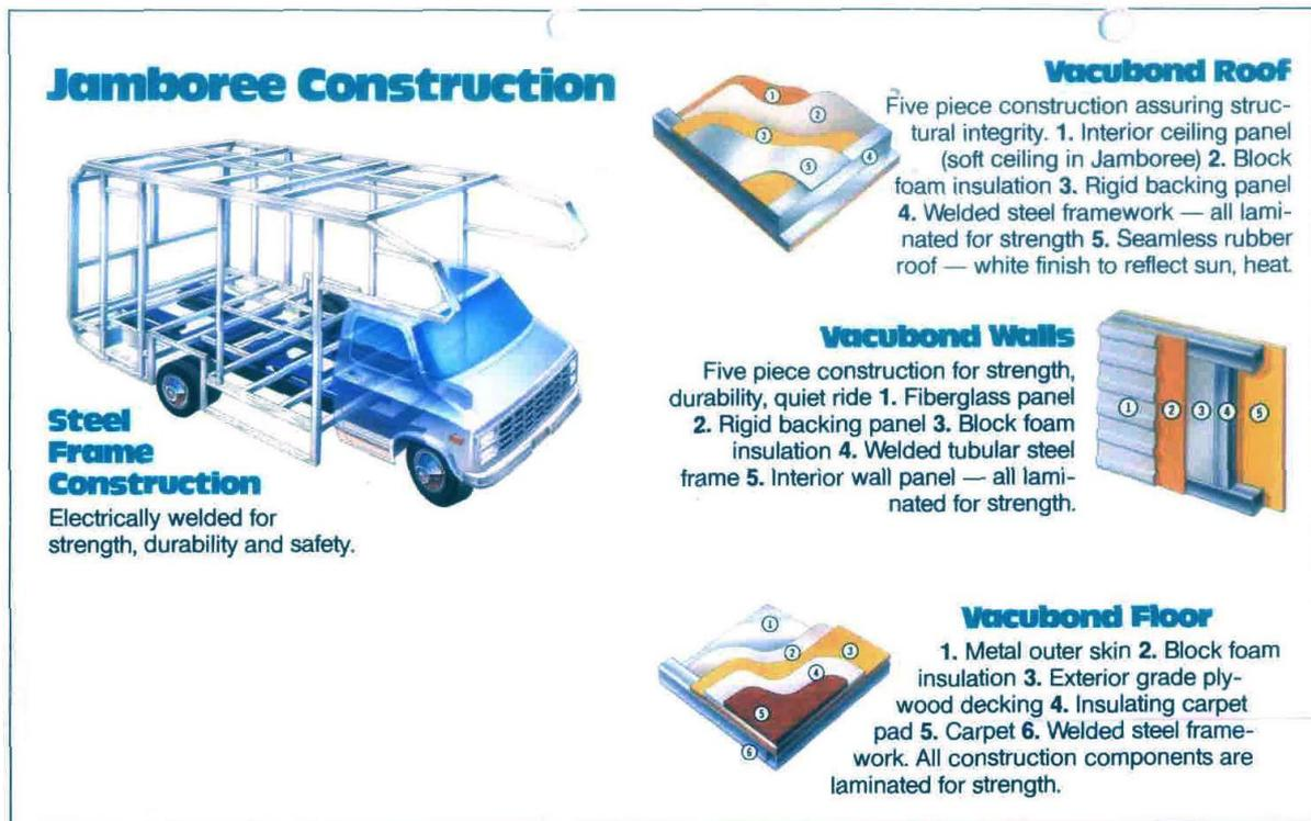
massive Stahlrahmenkonstruktion, elektrisch geschweißt
